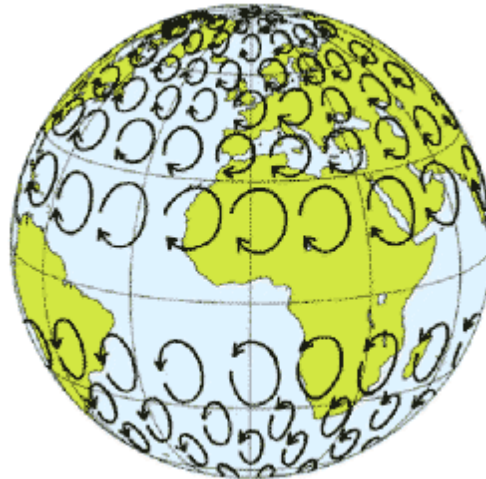
Figure 2.1 : Effet de la force de Coriolis sur la direction des vents, [112].
