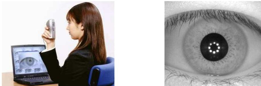
Figure 2.4 (a) Caméra de capture de l'iris par OKI, (b) Une image d'iris de CASIA-IrisV3-Interval [Mor 09].
