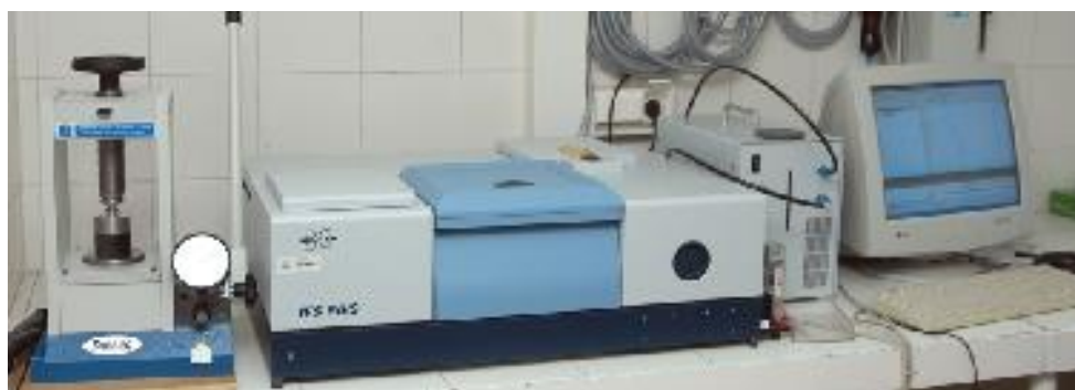
Photo II. 3. Spectromètre infrarouge à transformé de Fourier Bruker Alpha (Résolution allant jusqu'à 1 \text{cm}^{-1} ) - Université d'Alicante.
