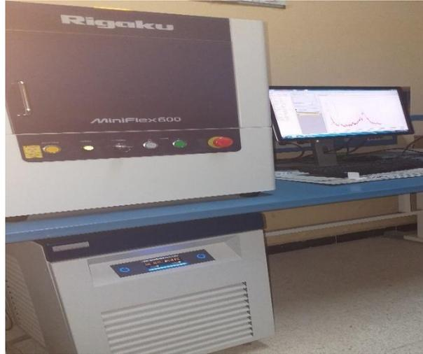
**Figure II.1.** Photographie du diffractomètre modèle Rigaku Mini Flex600.
