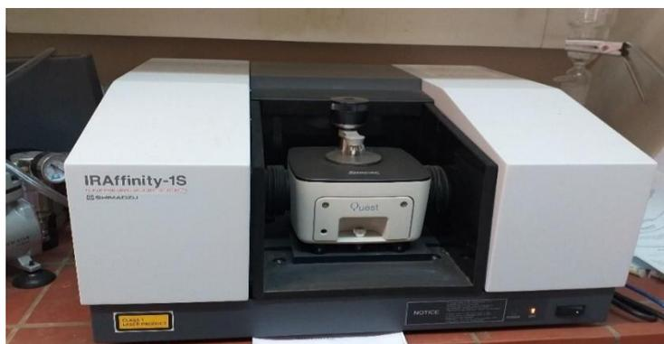
Figure II.3. Appareil de spectroscopie FT-IR.
