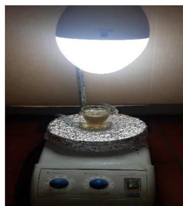
1. Représentation schématique du réacteur photocatalytique.
