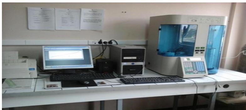
**Figure II.7.** Photographie du dispositif expérimental de l'analyse d'adsorption-désorption d'azote (BET).
