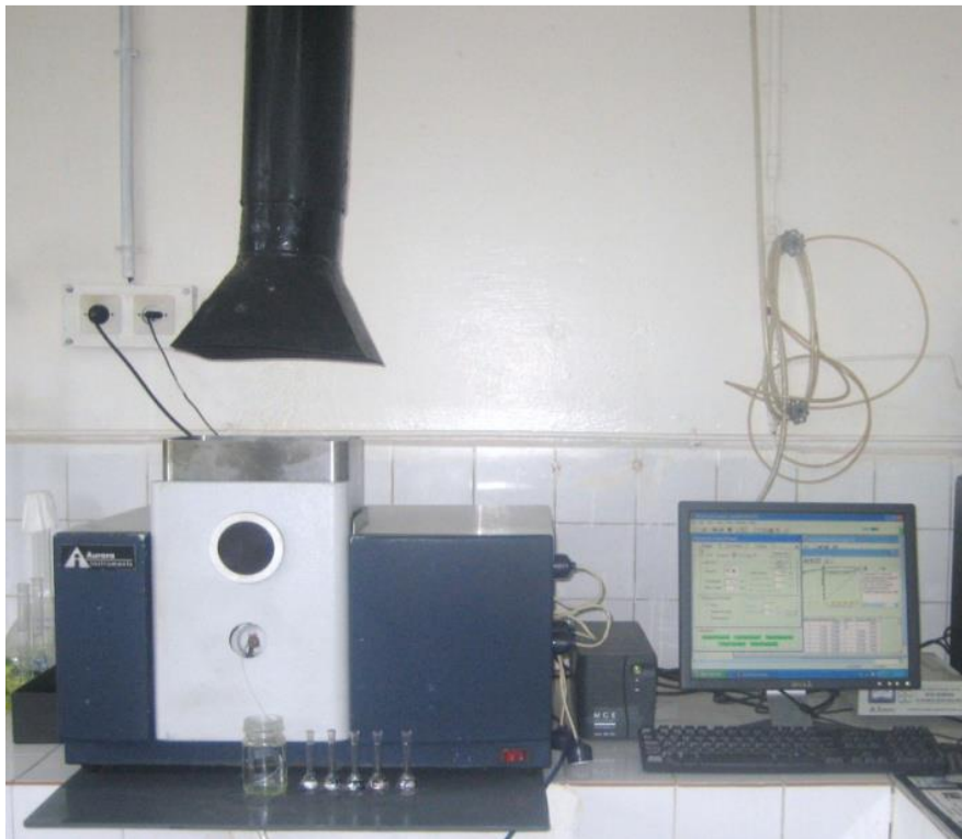
Figure III.2 : Spectrophotomètre d'absorption atomique à flamme (SAAF) de type AURORA AI.1200
