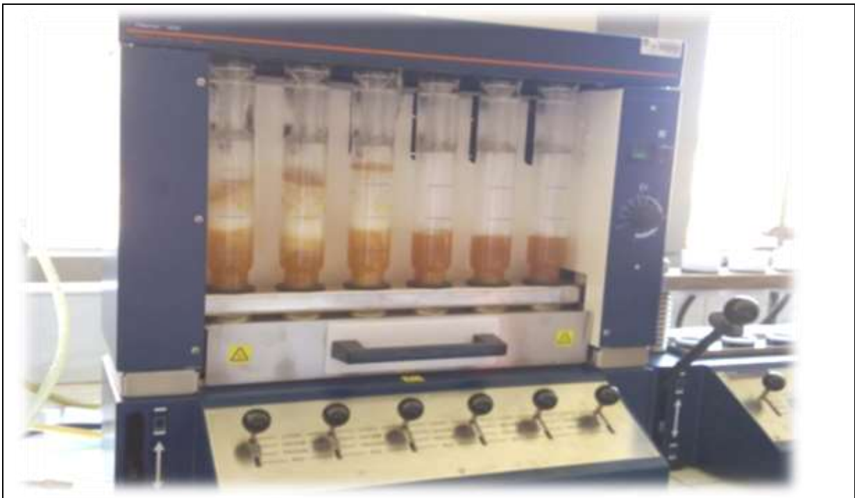
Figure 12 : Dosi-fibre SELECTA unités de traitement à chaud (gauche) et à froid (droite)
