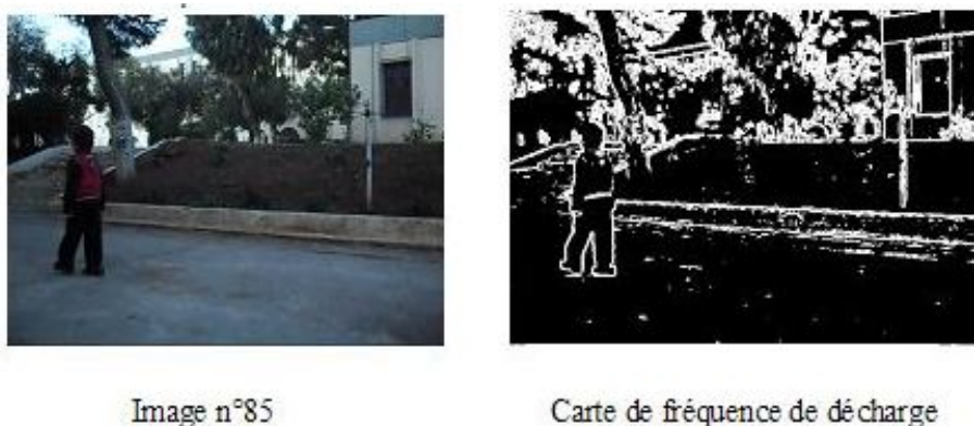
FIG. 5.3 – Carte de fréquence de décharge pour une image de la séquence
