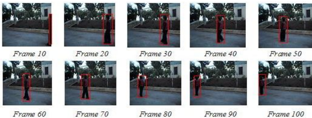
FIG. 5.8 – Résultats de détection d'objet dans une séquence d'images
